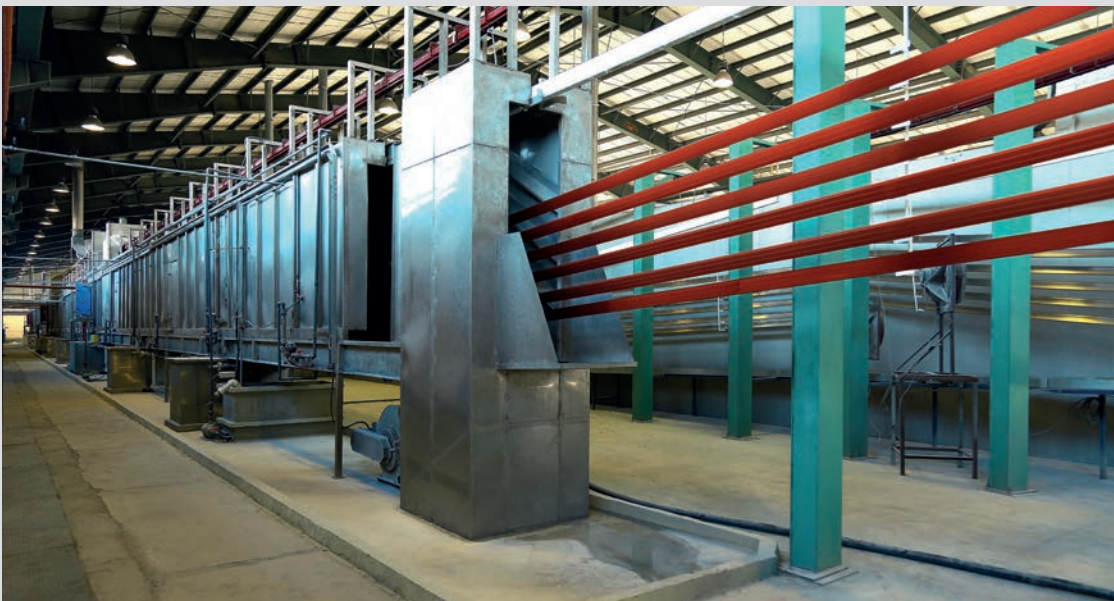
● خط رنگ الکترواستاتیک پودرکوتینگ MULLER آمریکایی با ظرفیت رنگ ۳۰۰۰ تن در سال ● American MULLER Powder Coating Electrostatic Paint Line with 3000 tones color capacity per year
